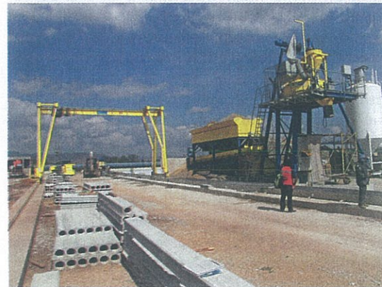
Abb. 2 Production of hollow core slabs. Abb. 2 Produktion von Hohldecken.
